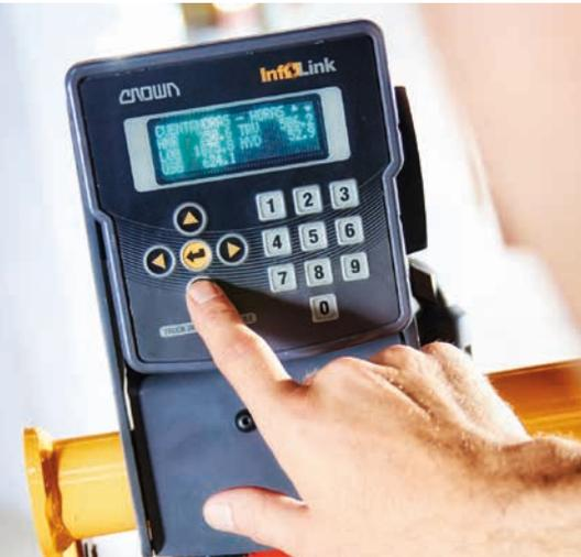
▲ Mit dem Info Link-System spart Palibex Kosten. Das System prüft täglich jedes einzelne Detail des Staplerbetriebs, so etwa Schichtbeginn und Einsatzende, die Zeit, die jeder Mitarbeiter mit dem Bedienen von Staplern und Gabeln verbringt, den Energieverbrauch und vieles mehr (Fotos: Crown)
