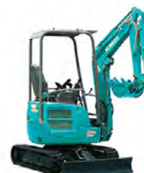
Kobelco 17SR Mini Excavators, 2021
