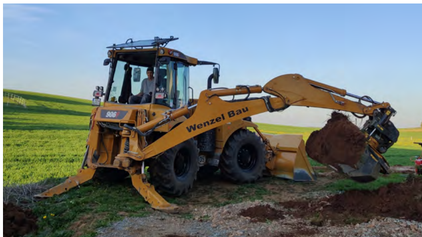
Mit dem 280 Grad Schwenkbereich kann das Material auch seitlich verladen werden.
