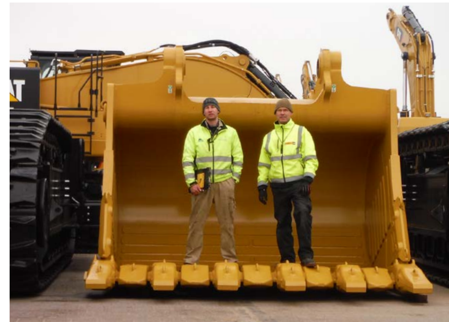
Als die Vertreter von MEVAS im Hafen von Antwerpen waren, um mehrere Motorgrader zu inspizieren, stießen sie auf diesen Bucyrus-Bagger mit einem 6 m³ Löffel. Er wurde für den Transport demontiert Bildquelle: MEVAS
