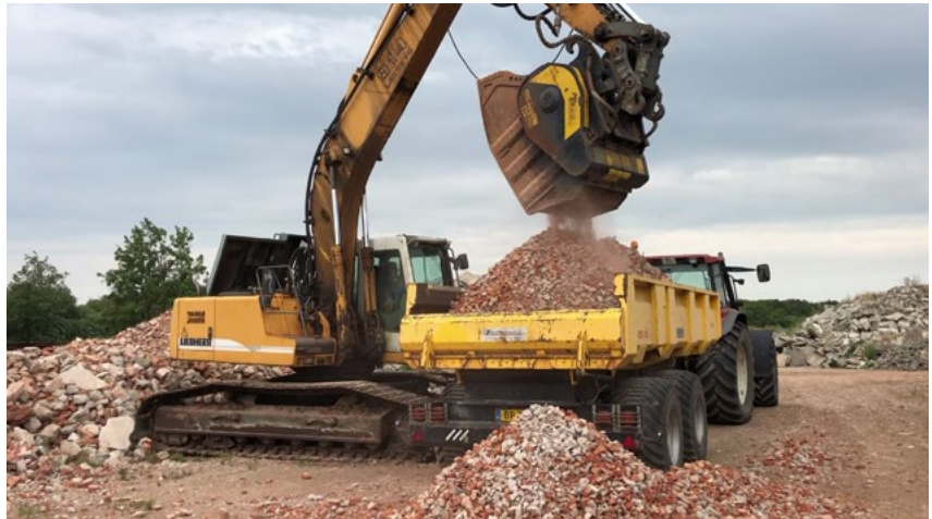
BF90.3 Backenbrecherlöffel mit Liebherr 914 Raupenbagger
