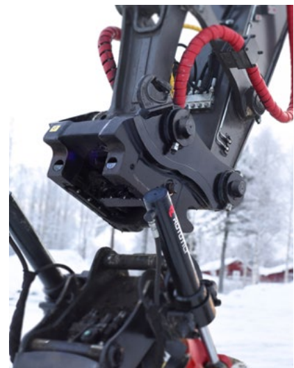
QuickChange™ ermöglicht Baggerfahrern, das hydraulische Anbaugerät zu wechseln, ohne die Kabine zu verlassen.
