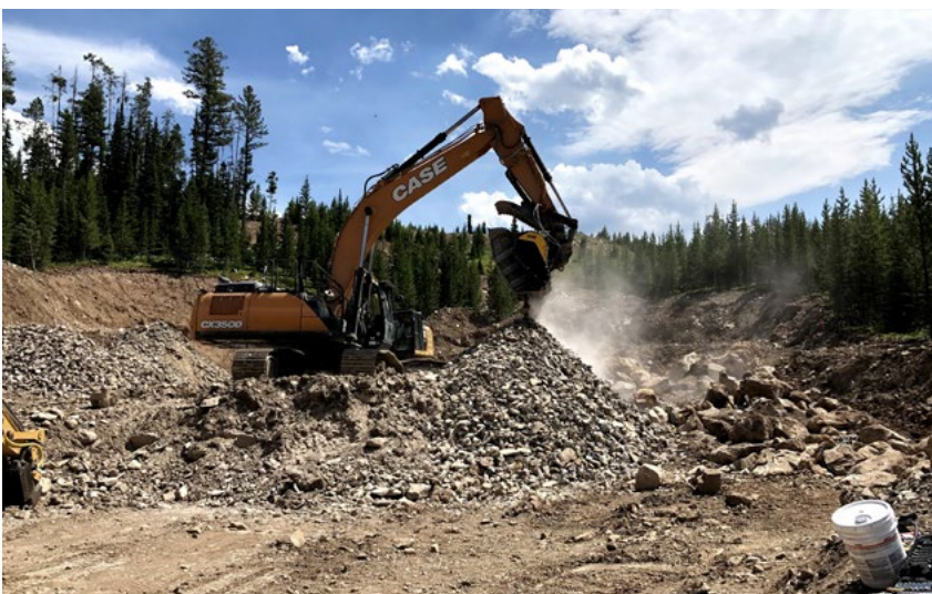
BF120.4 Backenbrecherlöffel mit Case CX350D Raupenbagger
