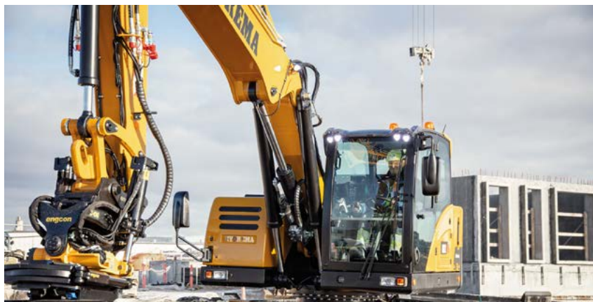
Die Baureihe MX G verfügt über eine überarbeitete Fahrerkabine mit vier LED-Arbeitsscheinwerfern im Kabinendach und bis zu 7 zusätzlichen LED-Leuchten, die den Betrieb bei Nacht sicherer und effizienter machen. Zudem ist die Kabine serienmäßig mit einer Ein- und Ausstiegsbeleuchtung und voll verstellbaren Armlehnen ausgestattet.
