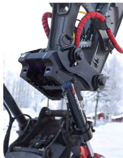
QuickChange™ ermöglicht Baggerfahrern, das hydraulische Anbaugerät zu wechseln, ohne die Kabine zu verlassen.
