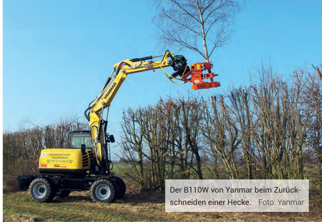
Der B110W von Yanmar beim Zurückschneiden einer Hecke. Foto: Yanmar
