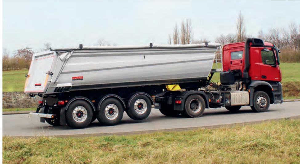
Eine um 20° geneigte Stirnwand sorgt für eine optimale Entleerung. 26 m<sup>3</sup> Ladevolumen sind beim SMART-Stahl-Halbschalenkipper bereits ab einem Leergewicht von 5600 kg verfügbar. Foto: Langendorf
