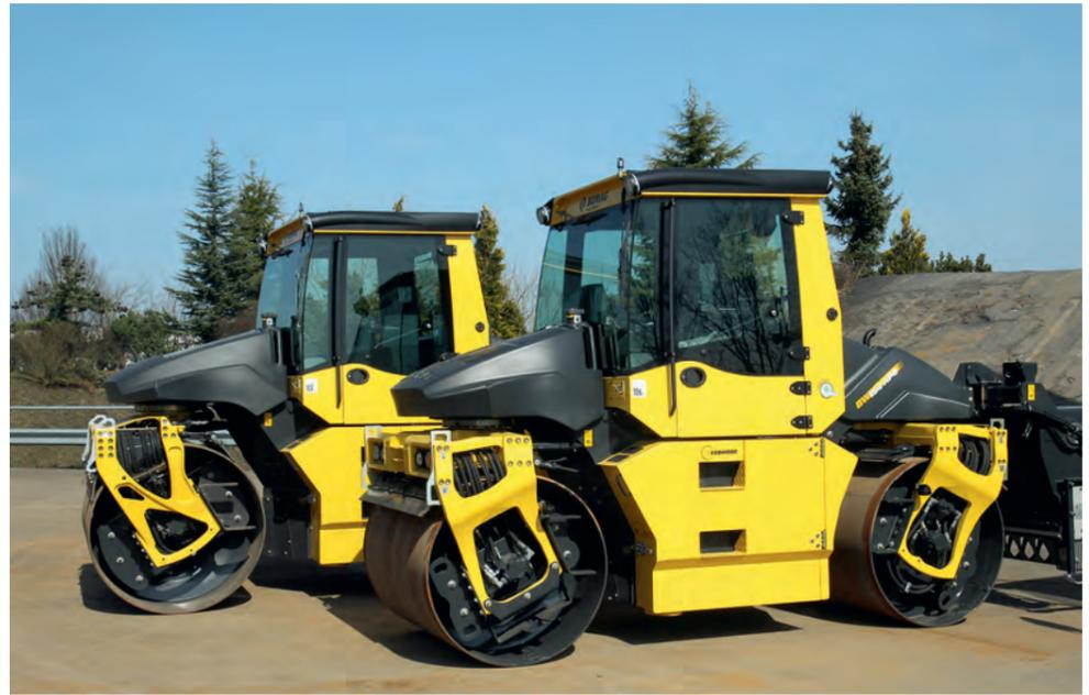
Mit der Tango4-Technologie ist eine sanfte Verdichtung auch auf Brücken möglich.
